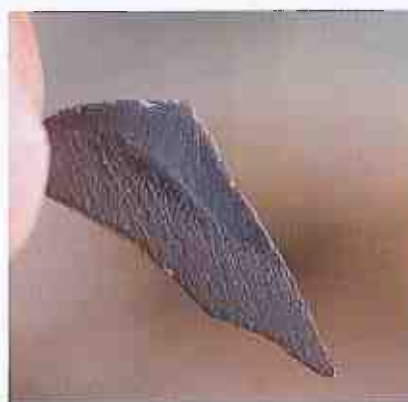
Fig. 7. Saint-Guilhem-le-Désert (Hérault), autel ; vue d'une plaque de verre présentant des dégradations (rayures sur la surface du verre) et une partie bien conservée. © Benoît Lafay, 2017.
